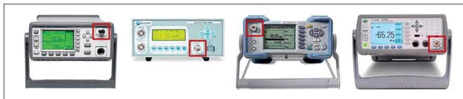
Рис. 1. Выход источника эталонного сигнала 1 мВт (0 дБм) 50 МГц из измерителях мощности
