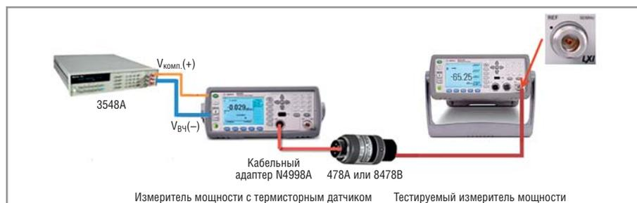
Рис. 2. Типовая схема измерений эталонной мощности 1 мВт 50 МГц [2]
