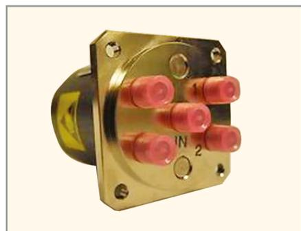
Рис. 6. Внешний вид электромеханических ключей SP4T
