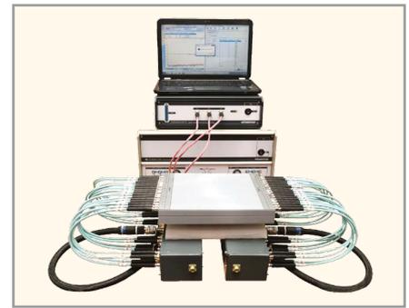
Рис. 8. Внешний вид комплекса К2М-102, скоммутированного для калибровки
