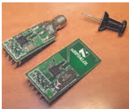
Рис. 9. Внешний вид модулей трансивера на базе nRF24L01 с печатной и внешней антенной
