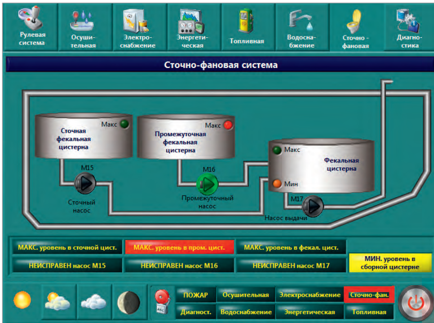
Рис. 2. Мнемосхема «Сточно-фановая система»
