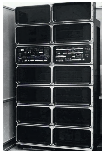
Рис. 5. Типовой шкаф ЭВМ М-13
