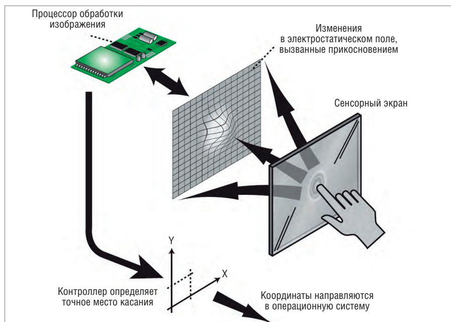
Рис. 8. Принцип действия ёмкостного сенсорного экрана
