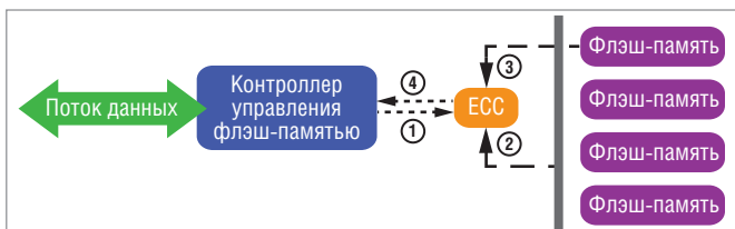
Рис. 1. Принцип действия технологии ECC
