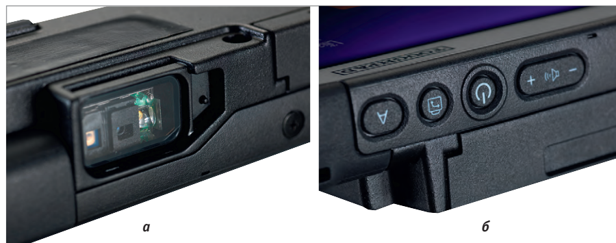
Рис. 5. Расположение на модели FZ-B2 сканера штрих-кодов (а) и кнопок управления планшетом (б)
