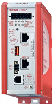
Рис. 7. Программно-аппаратный комплекс для защиты промышленного IT-контура Tofino Xenon
