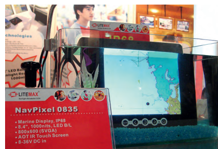
Рис. 5. Дисплей NPD0835, погруженный в воду, продолжает работать
