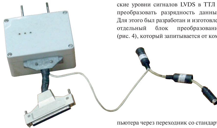
Рис. 4. Блок преобразования интерфейсов
