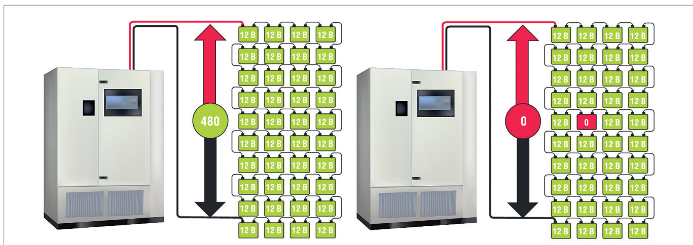
Рис. 1. Лишь одна неисправная ячейка способна нарушить работу всего массива
