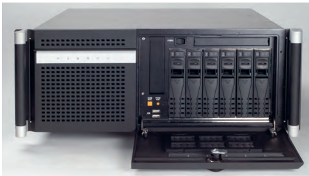
Рис. 7. 4U-корпус для промышленного сервера хранения Advantech ACP-4362
