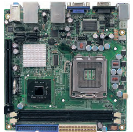
Рис. 2. Компактная промышленная материнская плата формата Mini-ITX iBASE MI900
