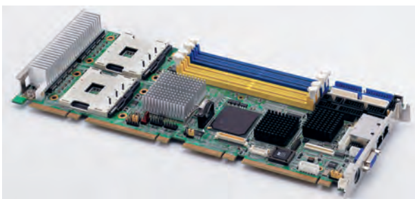
Рис. 5. Двухпроцессорная плата стандарта PICMG 1.3 Advantech PCE-7210
