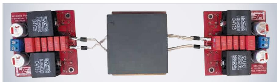
Рис. 6. Испытание системы беспроводной передачи энергии с воздушным зазором 6,5 мм ( $V_{in} = 20$  В постоянного тока,  $P_{out} = 100$  Вт)
