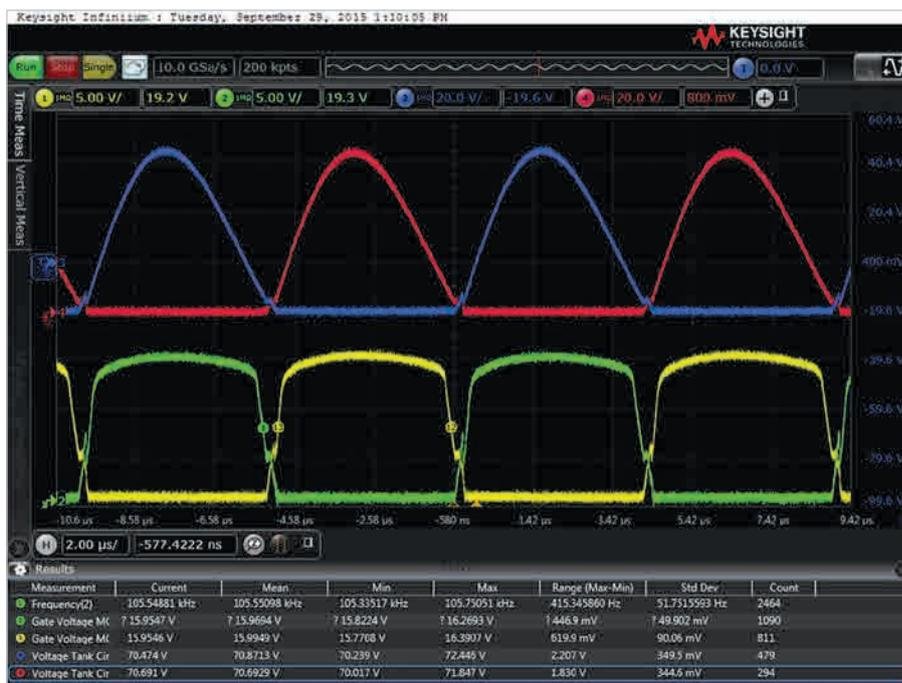
Рис. 3. Осциллограммы напряжений, измеренных на стоках транзисторов (концах катушки передатчика), показаны синим и красным цветом. Жёлтым и зелёным показана форма напряжения на затворах. Напряжения измерены относительно общего провода (GND) при напряжении питания  $V_{in} = 20$  В и выходной мощности  $P_{out} = 100$  Вт
