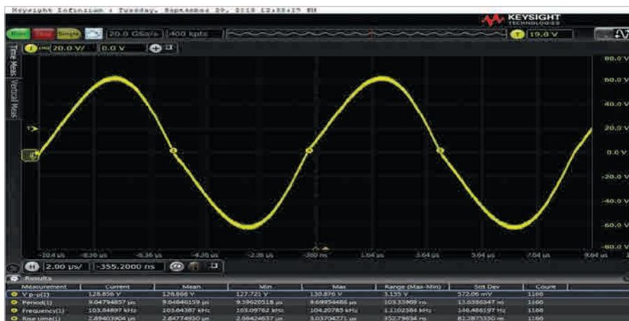
Рис. 4. Осциллограмма напряжения непосредственно на катушке передатчика без привязки к общему проводу GND при  $V_{in} = 20$  В и  $P_{out} = 100$  Вт
