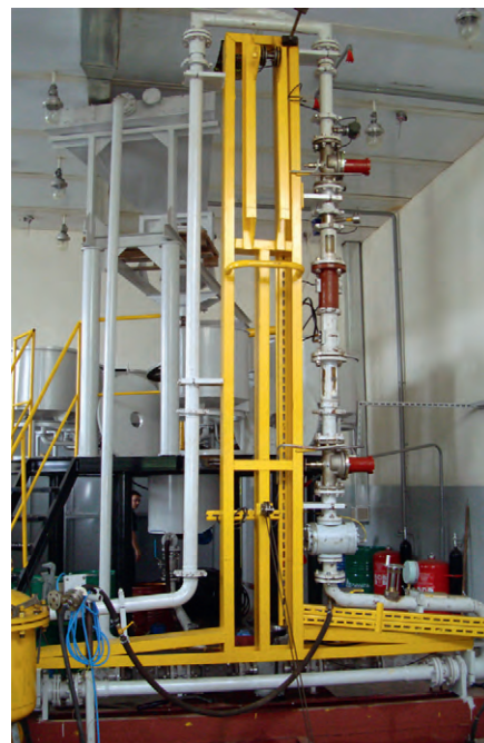
Рис. 13. Общий вид трёхкомпонентного двухфазного динамического стенда «Поток» в вертикальном положении с установленным в нём зондирующим блоком влагомера «Сател-РВВЛ»
