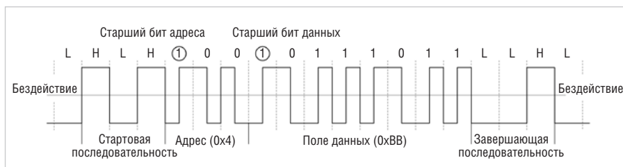
Рис. 2. Пример стартовой и завершающей последовательностей, построенных на основе четверичных символов в сочетании с манчестерским кодированием
