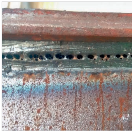
Рис. 8. Пример дефектного изделия, выявленного электронным способом, основанным на идеях Соколова
