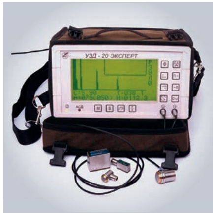
Рис. 9. Один из первых портативных дефектоскопов отечественного производства УЗД-20
