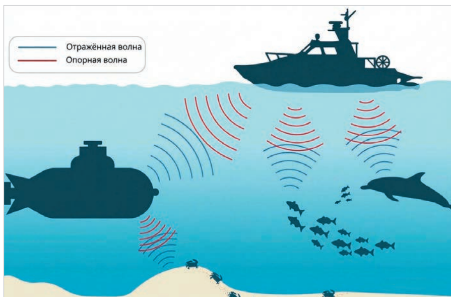
Рис. 3. Способ акустического обнаружения подводных препятствий, предложенный С.Я. Соколовым
