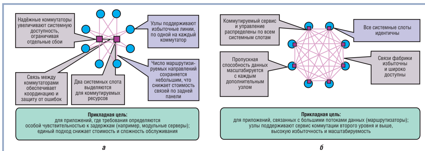
Рис. 8. Топологии комммутирующих фабрик «двойная звезда» (а) и «полносвязная ячеистая сеть» (б)
