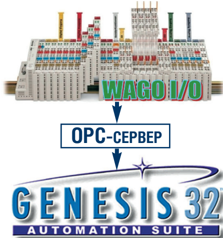
Рис. 1. Система состоит из каплера WAGO I/O 750-342, OPC-сервера и SCADA GENESIS32
