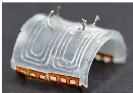
Рис. 3. Полимерная площадка с проводящим электрический ток элементами – основа миниатюрного робота австрийского производства
