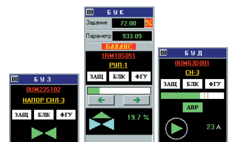
Рис. 18. Блоки управления в подсистеме ДУ
