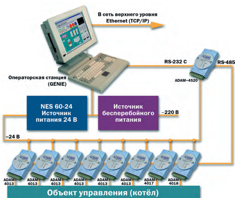
Рис. 1. Блок-схема автоматизированной системы контроля параметров водогрейного котла КВГМ-180
