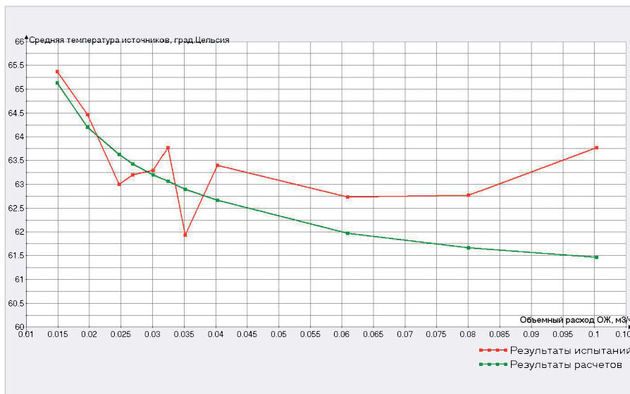
Рис. 14. Результаты испытаний макета корпуса для X-диапазона: зависимость средней температуры имитаторов (источников нагрева) от объемного расхода охлаждающей жидкости (Источник: Ю.О. Соляев, МАИ)
