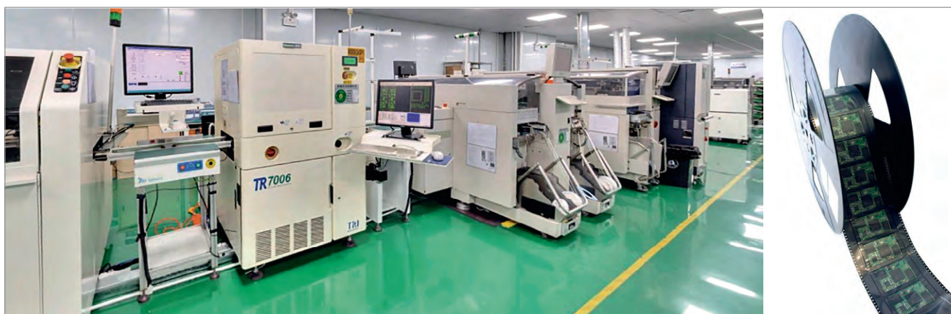
Рис. 7. OSM в ленточной упаковке на автоматической линии монтажа электронных компонентов
