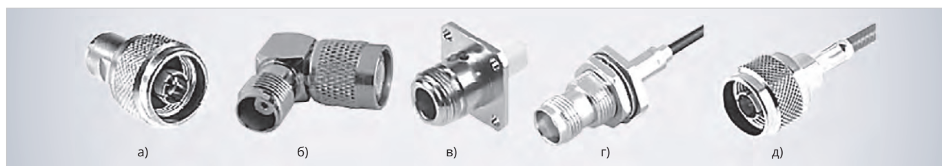
Рис. 5. Соединители N: прямой кабельный (а), угловой кабельный (б), вывод энергии фланцевый (в), кабельные сборки с гибким кабелем (г) и с полужёстким кабелем (д)
