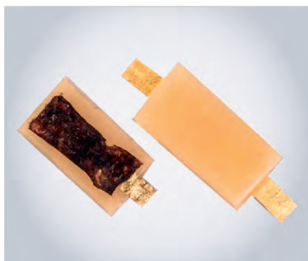
Рис. 1. Готовая к употреблению биоразлагаемая батарея производства Istituto Italiano di Tecnologia
