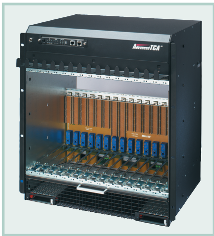
Рис. 6. Системное шасси AdvancedTCA, соответствующее стандарту PICMG 3.0
