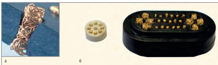
Рис. 1. Компрессионный проволочный контакт: а – на плате; б – в соединителях
