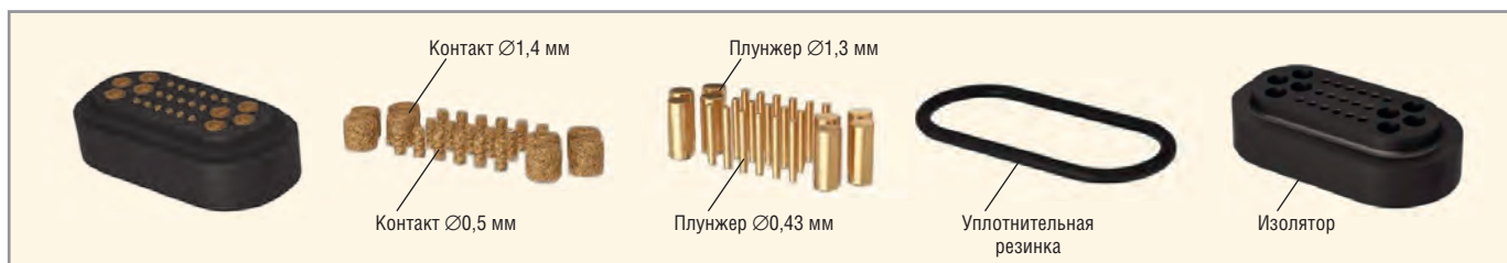
Рис. 5. Конструкция соединителей типа СКП399
