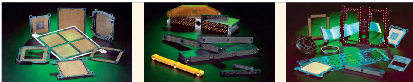
Рис. 3. Многовыводные платы и контактирующие устройства с проволочными контактами
