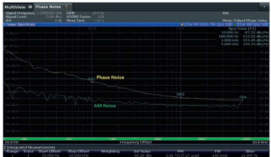
Рис. 15. Результаты измерения фазового и амплитудного шумов импульсной несущей с помощью анализатора R&S FSWP
