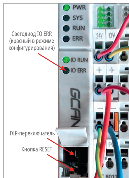
Рис. 11. Расположение кнопки «RESET» и DIP-переключателя на модуле GCAN-IO-8100
