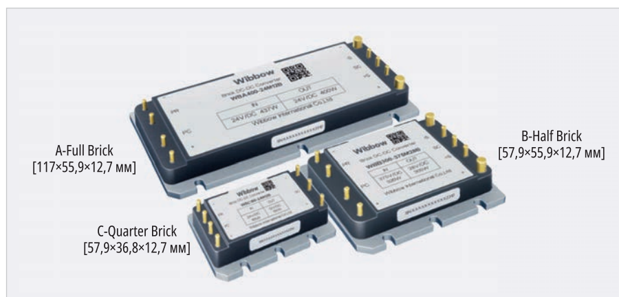
Рис. 3. Внешний вид модулей семейства Brick 2-го поколения с выводом «PR» двунаправленного цифрового порта для синхронизации частоты преобразования и равномерного распределения мощности нагрузки между отдельными однотипными модулями при параллельном включении
