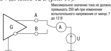
Рис. 10. Схема проверки формирователя в условиях возникновения конфликтных ситуаций
