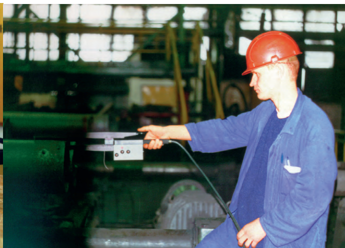
Рис. 1. Внешний вид автоматизированной системы «Стенкомер СЦ-50» и пример ее практического использования
