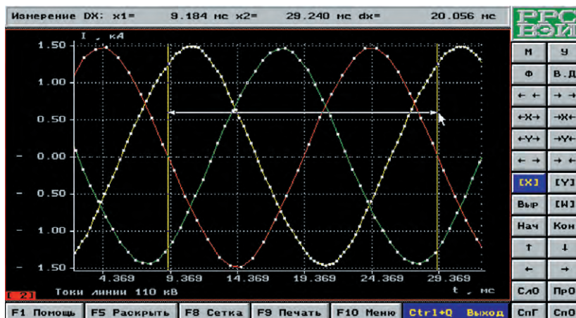
Рис. 5. Трехфазная система токов с разной частотой дискретизации
