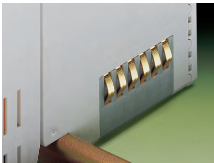
Рис. 6. Реализация шины данных в контроллере WAGO I/O-System
