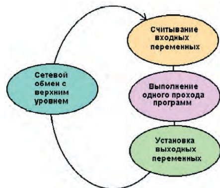
Рис. 2. Циклограмма функционирования системы исполнения на целевом контроллере
