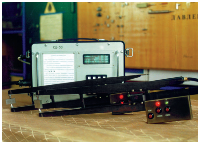
Рис. 1. Внешний вид автоматизированной системы «Стенкомер СЦ-50» и пример ее практического использования
