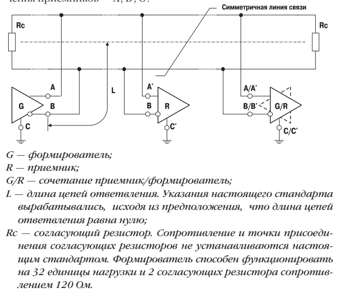
Рис. 1. Многоточечная система связи
