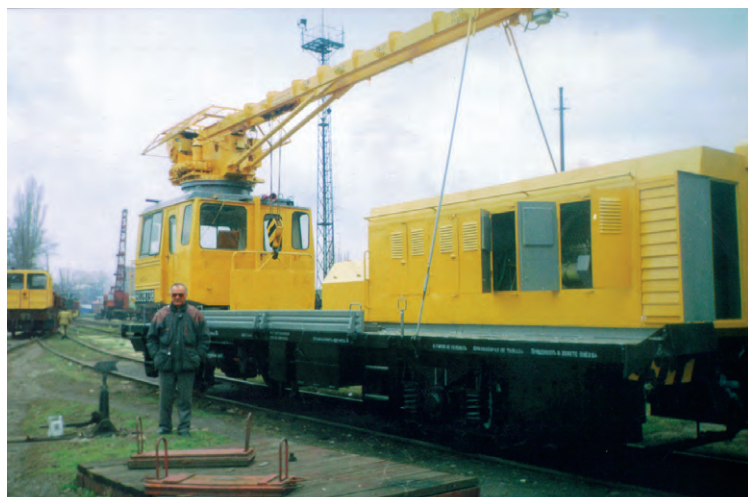
Рис. 1. Объект автоматизации — мотовоз погрузочно-транспортный МПТ-4
