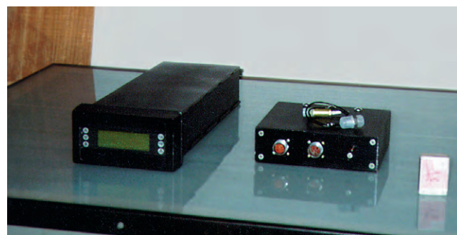
Рис. 4. Регулятор-оптимизатор и блок нормирующих преобразователей
