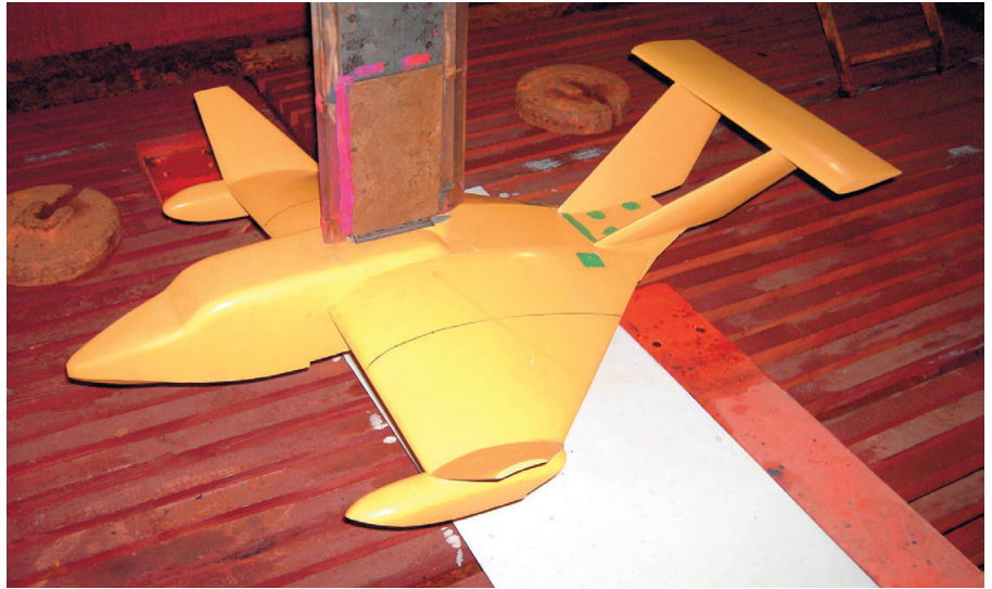
Рис. 3. Модель экраноплана в опытном бассейне
