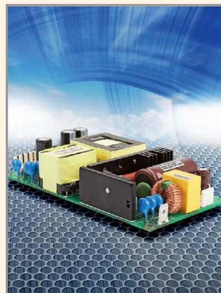
Дополнительный специальный канал 12 В / 0,5 А, предназначенный для питания вентилятора, является стандартным для всех моделей.
