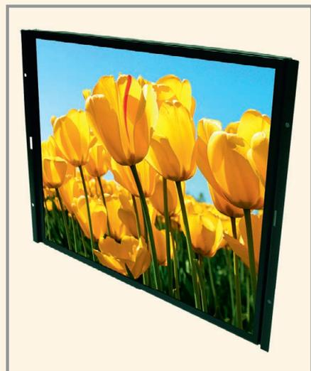
Высокая яркость  $400 \text{ кд/м}^2$ , обеспечиваемая светодиодной системой подсветки, позволяет считывать изображение с экрана даже при солнечном освещении. Встроенный драйвер системы подсветки обеспечивает регулировку яркости в широком диапазоне. В конструкции дисплея применяются светофильтры поляризаторы с высоким коэффициентом пропускания, что обеспечивает низкое энергопотребление. Запроектирован интерфейс HDMI 1.4.
