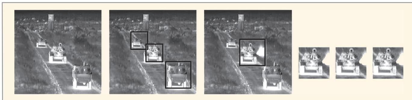
Рис. 7. Последовательность изображений – первое с полным разрешением и обновлением с частотой 100 Гц, следующие – с обновлением выделенной области интереса с частотой 1000 Гц
