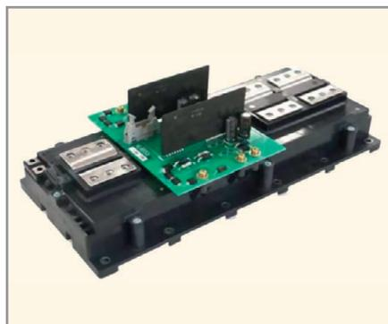
Рис. 13. Драйвер на модуле New-MPD
