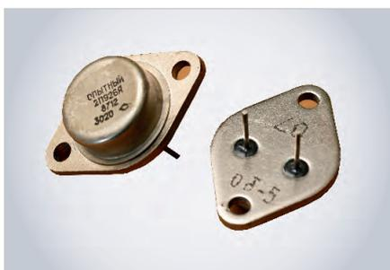
Рис. 1. Внешний вид транзистора серии КП926
