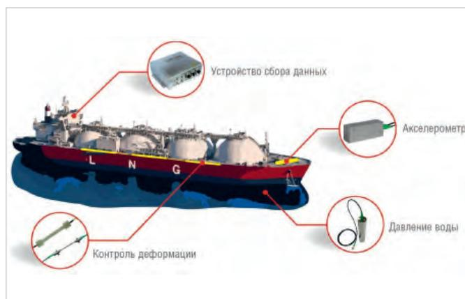
Рис. 9. Иллюстрация размещения оптических датчиков на корпусе танкера
