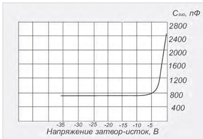
Рис. 5. Зависимость ёмкости затвор-исток от напряжения затвор-исток транзисторов КП926А, Б
