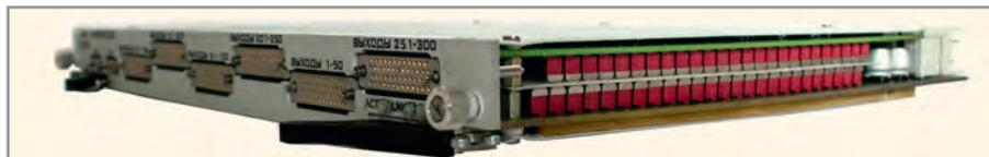
Рис. 8. Коммутатор ВВК-AXIe-0 на 300 каналов
