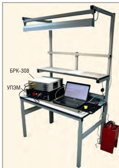
Рис. 4. Пример системы TEST-9110-LXI на 144 канала 3500 DC / 2500 AC
