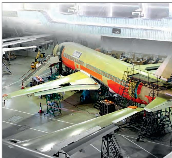
Рис. 1. Комплекс ТЕСТ-9110 в процессе тестирования систем самолёта SSJ-100 в г. Комсомольск-на-Амуре
