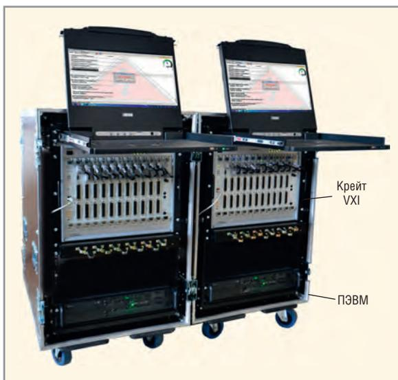
Рис. 6. Пример двух систем TEST-9110-VXI на 4400 каналов 1050 DC / 750 AC
