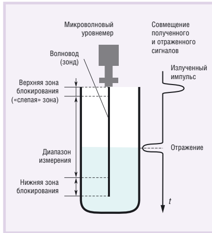
Рис. 1. Совмещение излученного и отраженного сигналов при реализации метода направленного электромагнитного излучения
