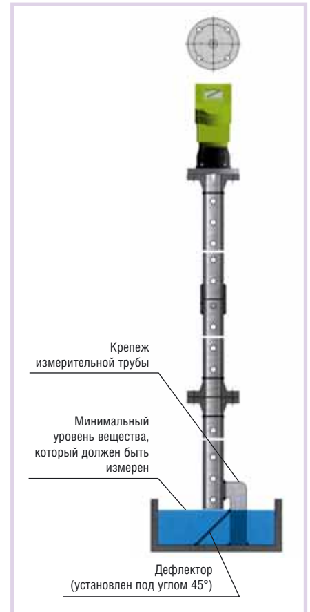
Рис. 5. Пример установки микроволнового бесконтактного уровнемера на успокоительную трубу
