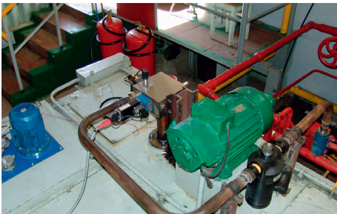
Рис. 6. Экспериментальные узлы управления адаптивного гидропривода
