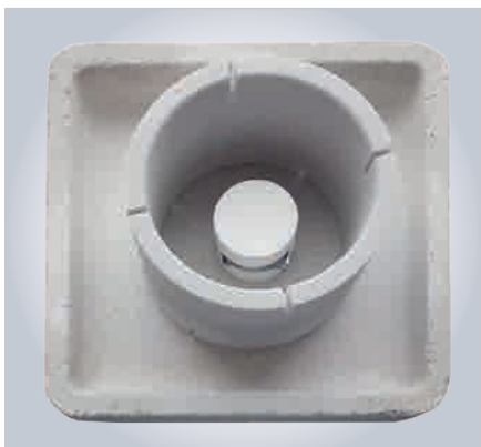
Рис. 5. Тигель без крышки для проведения пропитки УНТ кремнием, установленный в керамической огнеупорной лодочке
