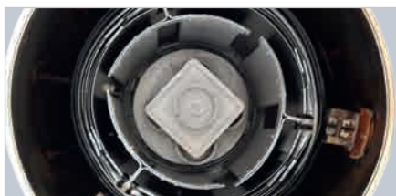
Рис. 6. Вакуумная камера установки Самсо с установленным диском из нитрида алюминия с УНТ и пластинами кремния перед пропиткой
