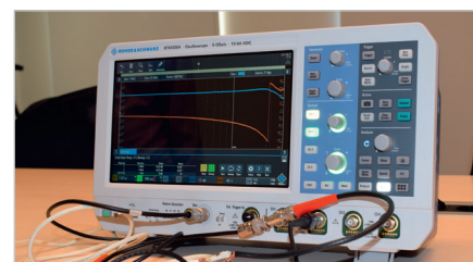
Рис. 6. Фотография измерительной установки для построения диаграммы Бode в целях расчёта функции Z(f)
