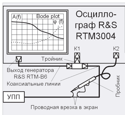
Рис. 3. Схема измерений импеданса УПП с использованием опции R&S RTM-K36
