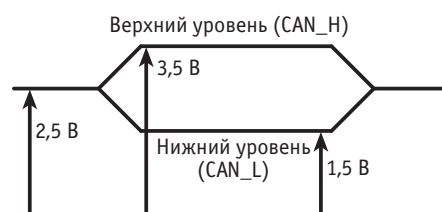
Рис. 1. Сигнальные уровни на CAN-шине
