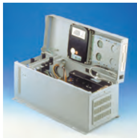
Рис. 7. Контроллер доступа на базе шасси IPC-6806 фирмы Advantech
