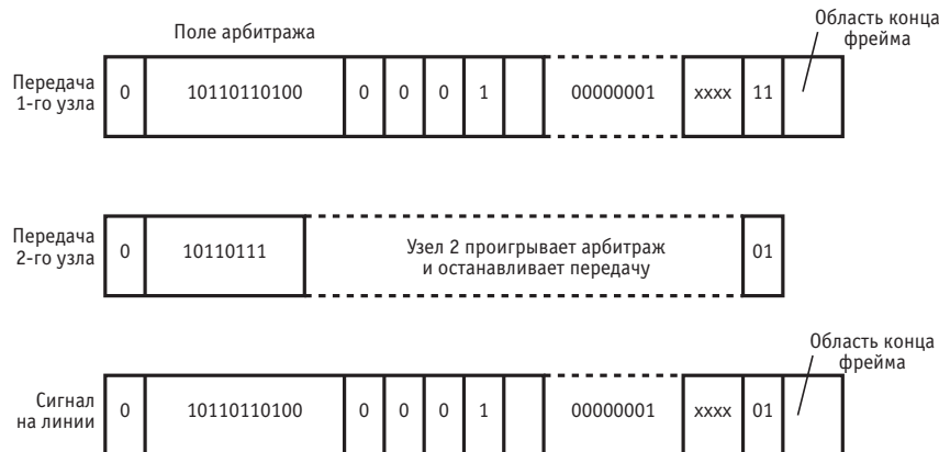
Рис. 6. Пример поразрядного арбитража
