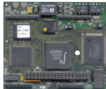
Рис. 12. Малогабаритный модуль фирмы Hilscher с интерфейсом CAN для производителей комплексного оборудования (OEM)
