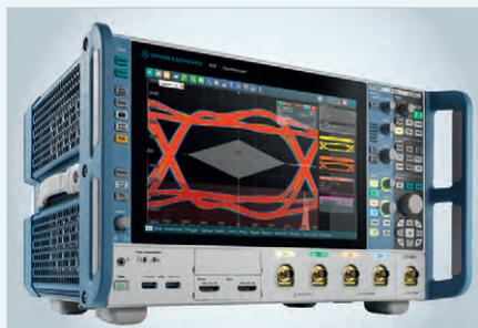
В дополнение к аналоговым каналам R&S RTP содержит 16 логических каналов, 4 канала измерения напряжения и 4 канала измерения тока.
