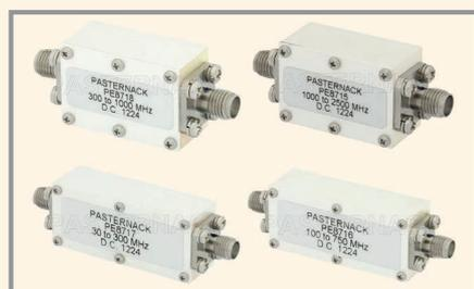
ВЧ-фильтры компании Pasternack поставляются с SMA-коннекторами, диапазон рабочих частот от 30 МГц до 2,5 ГГц, внешнее затухание менее 1 дБ. Конструкция ВЧ-фильтров позволяет добиться минимальных показателей КСВ и обеспечивать долговечность и надёжность работы.
