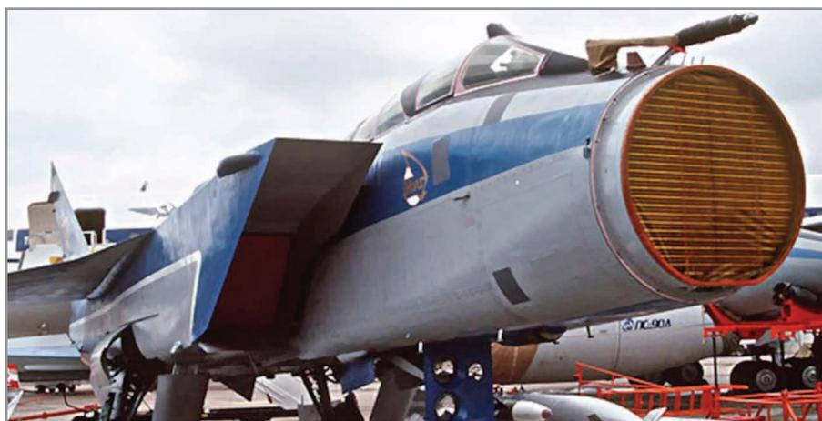
Рис. 1. Первый в мире истребитель, оснащённый РЛС, с пассивной ФАР, МиГ-31 (система «Заслон», НИИП им. Тихомирова)
