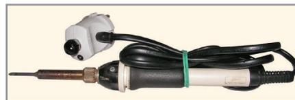
Рис. 4. Японский паяльник с керамическим нагревателем мощностью 15 Вт (лампа NE-2В – 3,8 × 10 мм, R3-СП4-1 – 33 кОм)
