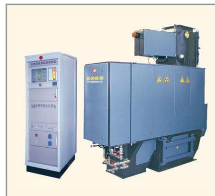
Рис. 5. Рентгенолюминесцентный сепаратор алмазов
