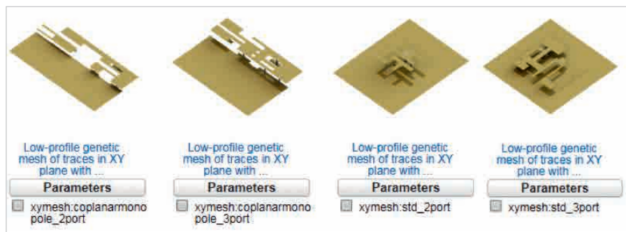
Рис. 3. Примеры решётчатых антенн в библиотеке AntSyn
