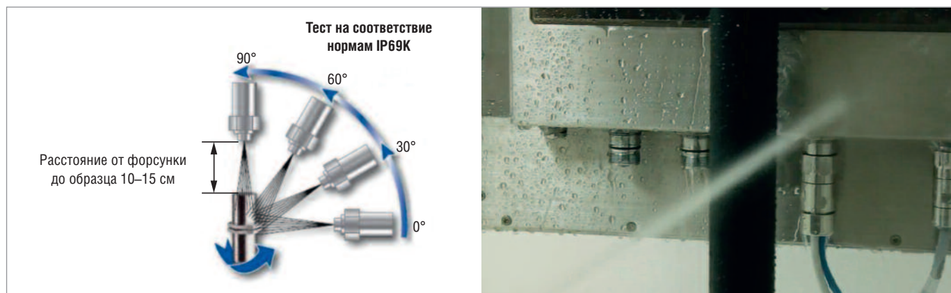
Рис. 2. Панельные компьютеры со степенью защиты IP69K способны выдерживать горячую мойку под давлением
