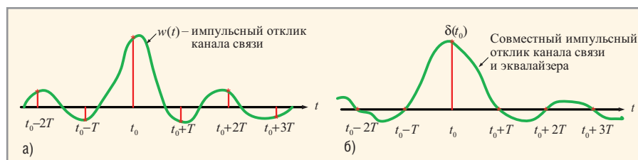
Рис. 20. Выравнивание электрического канала связи
