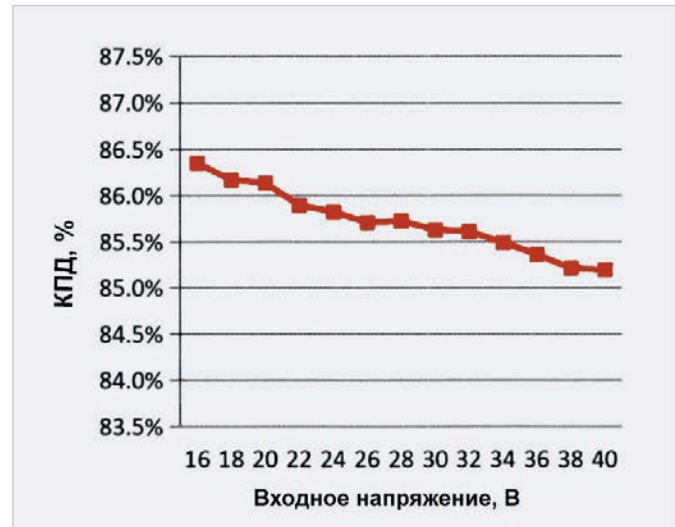
Рис. 7. Зависимость КПД от входного напряжения для модуля LFL2805S-CH
