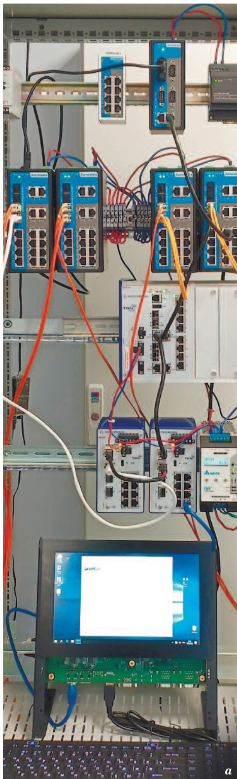
Рис. 9. Проверка совместной работы протокола MRP на коммутаторах Zonedata IES6200-PN и Hirschmann: а – устройства на стенде; б – схема сети при условии, что MRM Hirschmann; в – схема сети при условии, что MRM Zonedata IES6200-PN; г – результат проверок (MRM Hirschmann); д – результат проверок (MRM Zonedata)
