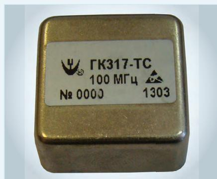
Рис. 1. Внешний вид ГК317-ТС, габаритные размеры: 25×25×12,7 мм
