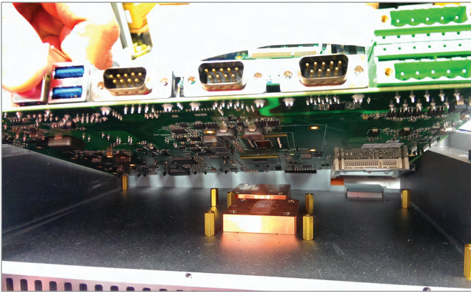
Рис. 2. Внутренняя конструкция системы пассивного охлаждения
