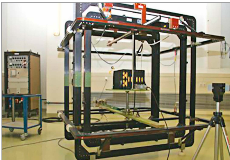
Рис. 6. Стенд для проверки на устойчивость к электромагнитным полям
