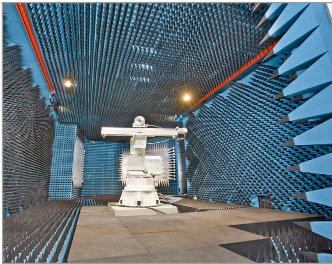
Рис. 2. Расположение антенного позиционера и коллиматоров внутри безэховой экранированной камеры антенного полигона
