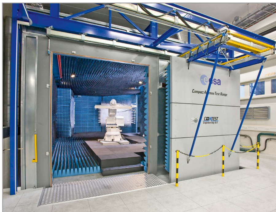
Рис. 1. Компактный антенный полигон Электромагнитной лаборатории
