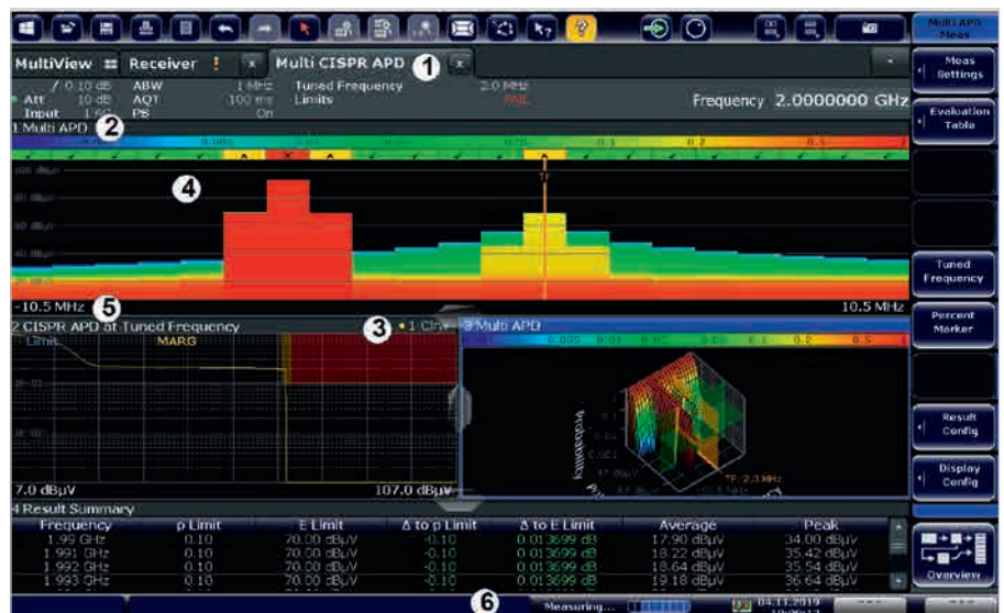
Рис. 9. Окно отображения результатов измерений опции R&S ESW-K58
