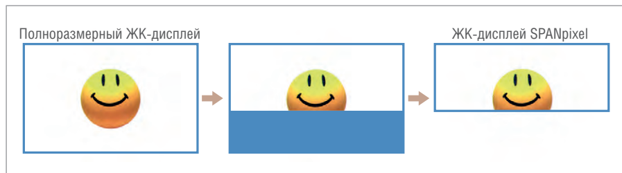
Рис. 9. Отображение полноразмерного медиаконтента на ЖК-дисплеях SPANpixel
