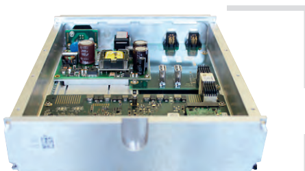
Рис. 3. Компоновка внутри корпуса компьютера BC50R
