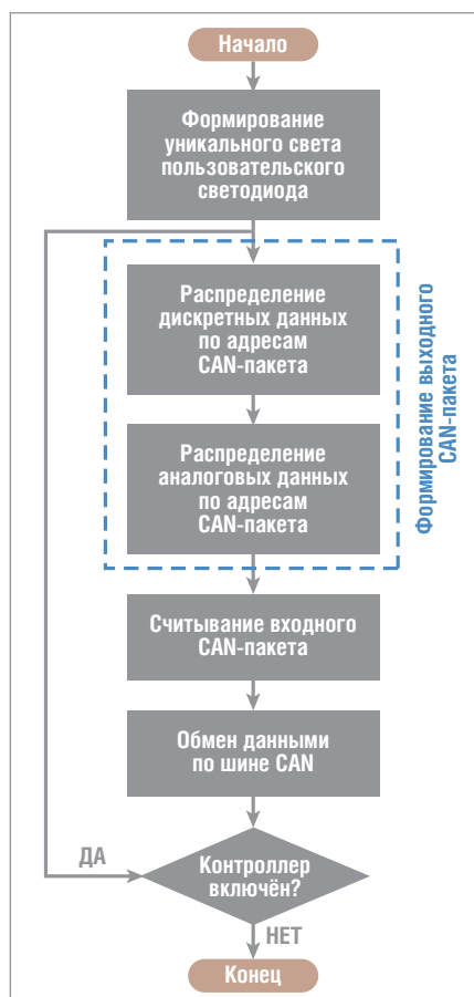
Рис. 6. Схема алгоритма программы нижнего уровня
