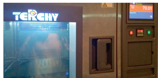
Рис. 3. Испытания при повышенных температурах (в климатической камере +70°C)
