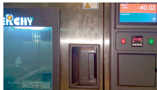
Рис. 4. Испытания при пониженных температурах (в климатической камере -40°C)
