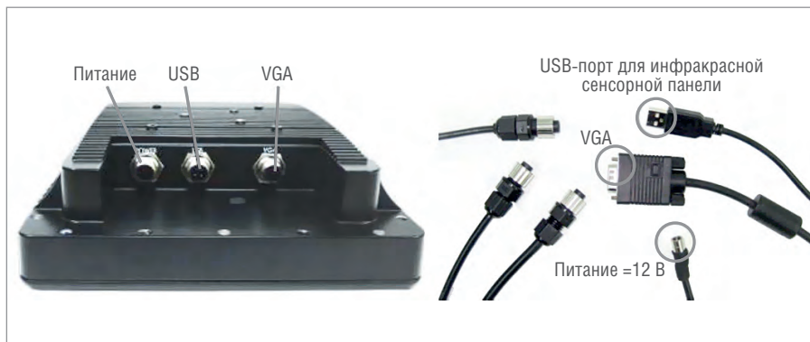
Рис. 16. Монитор NPD0835: коннекторы и кабели
