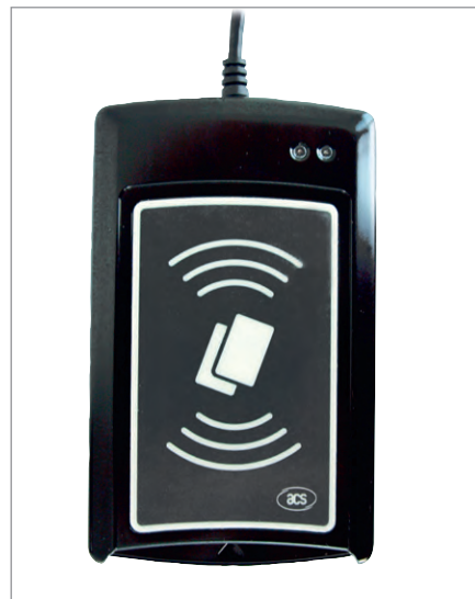
Рис. 11. Считыватель ACR1281U-C1 производства компании Advanced Card Systems
