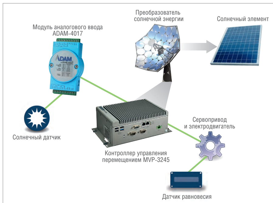
Рис. 4. Структура системы управления положением гелиоконцентратора
