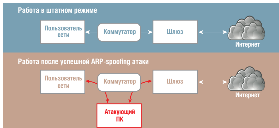
Рис. 2. Пример ARP-spoofing атаки
