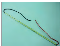
Рис. 1. Элемент матрицы задней подсветки ЖК-дисплея
