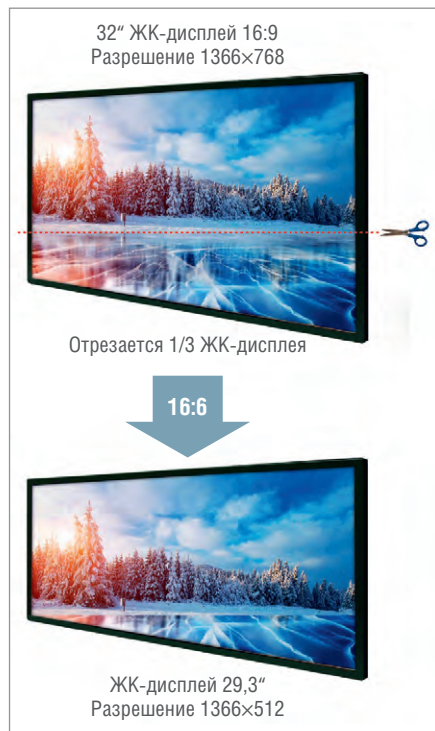
Рис. 6. Преобразование ЖК-дисплея формата 16:9 в формат 16:6
