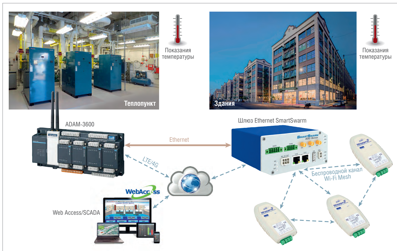
Рис. 2. Структура распределённой системы управления отоплением жилых массивов
