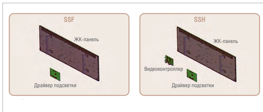
Рис. 13. ЖК-дисплеи серии SPANpixel: варианты конструкций SSF и SSH
