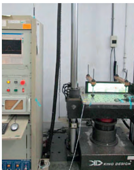
Рис. 7. Стенд испытаний на ударопрочность
