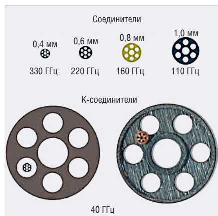
Рис. 4. Сравнительные размеры диэлектрических шайб соединителей мм-диапазона
