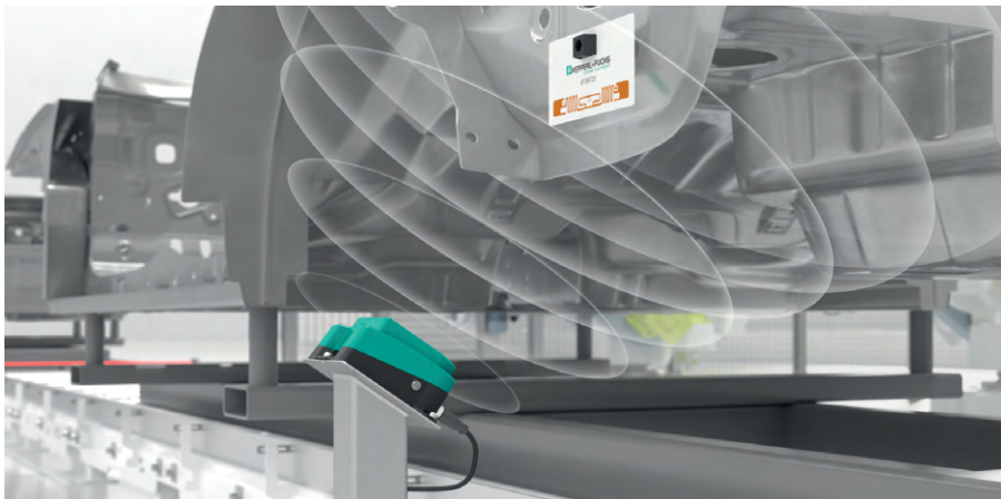
Рис. 4. Применение RFID-технологии на сборочном конвейере автозавода
