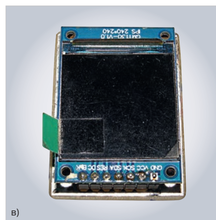
Рис. 4. Общий вид платы прибора: а) вид со стороны расположения компонентов; б) вид с обратной стороны без подключения дисплея; в) вид с обратной стороны с подключённым дисплеем
