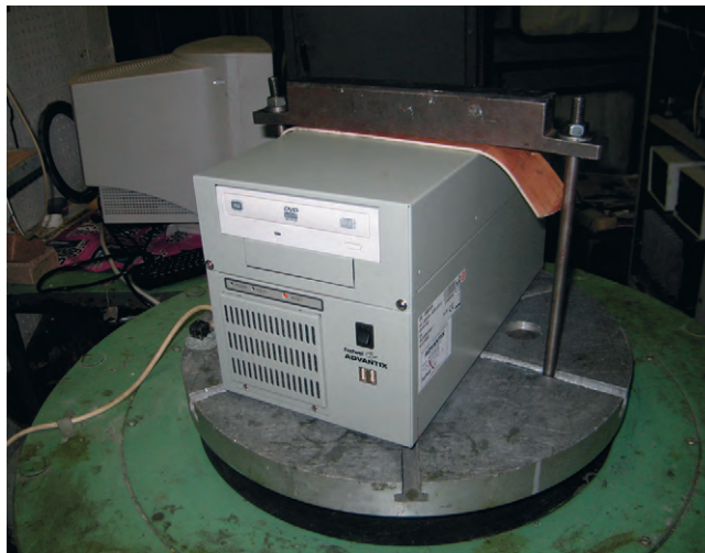
Рис. 22. Испытания AdvantiX ER УВМ1 на вибростенде
