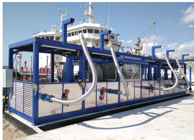
Рис. 5. Автоматическая установка разгрузки автотранспорта на 6 постов
