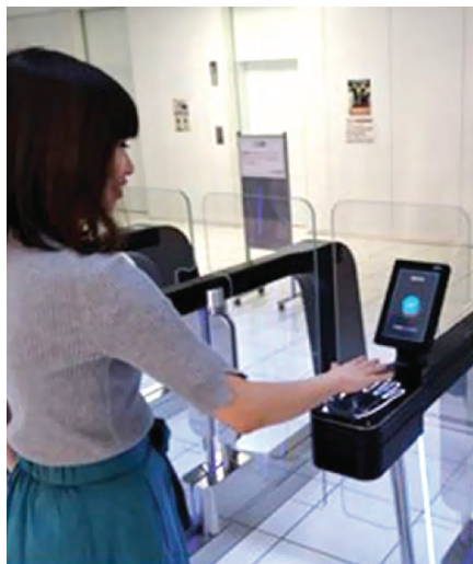
Рис. 7. Испытание биометрической системы на турникетах СКУД
