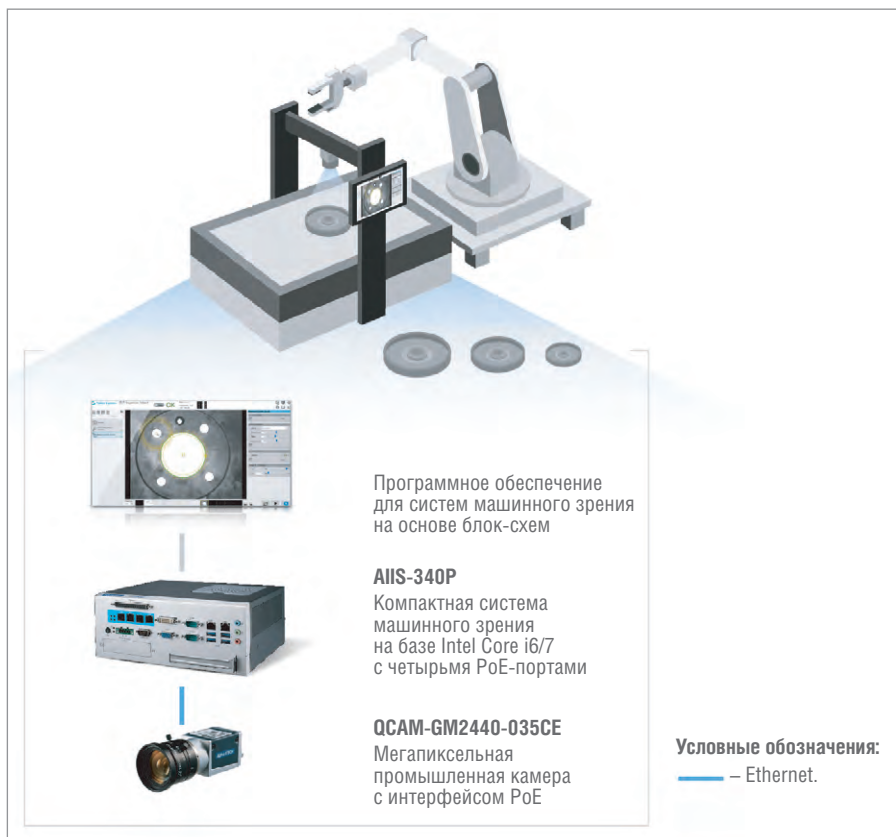
Рис. 7. Структура интеллектуальной системы машинного зрения VisionNavi
