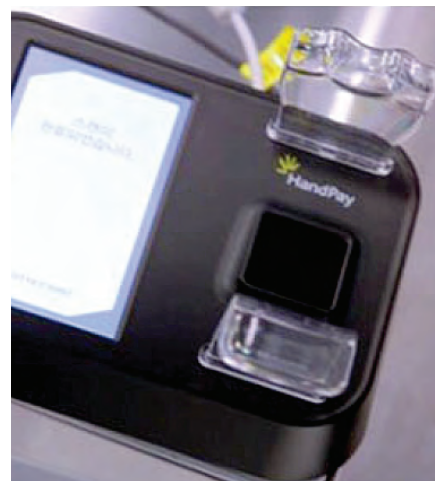
Рис. 8. Биометрический платёжный терминал с использованием технологии биометрической аутентификации по рисунку вен ладони
