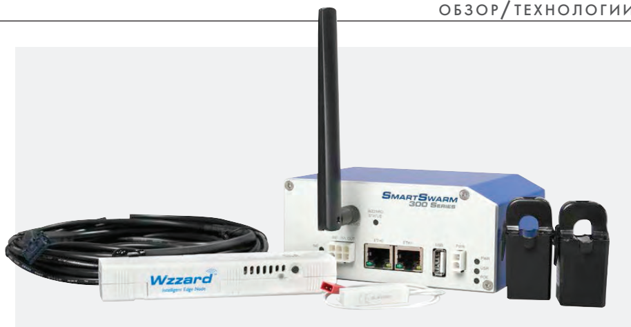
Рис. 9. Стартовый набор BB-WSK-REF-2 для мониторинга холодильных систем
